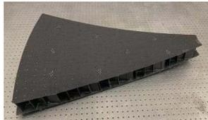
图 1 全碳纤维夹层结构原型面板
