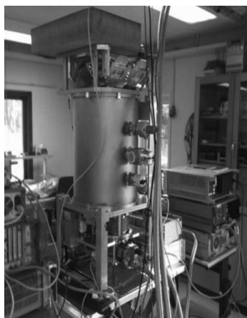
图 13 OSO 3 mm接收机双负载校准系统
