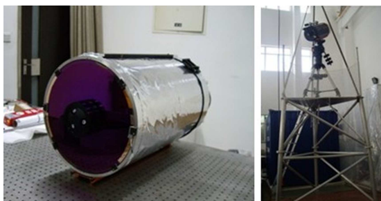
图 13 克服环境因素对视宁度测量的干扰. 左图: 经过白色包装的镜筒; 右图: 2.5 m 支撑塔架
